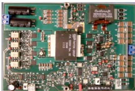
Fotografia 8. Przykład przetwornicy zasilającej dla telekomunikacji (SDM, 350 W)
