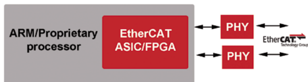
Rysunek 6. EtherCAT zintegrowany z procesorem
