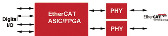
Rysunek 4. Urządzenie wejść/wyjść cyfrowych z interfejsem EtherCAT
