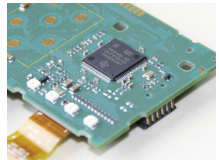
Fot. 3. W LOGO! OBA7 zastosowano mikrokontroler z rodziny Stellaris, z wbudowanym kompletnym interfejsem Ethernet (MAC+PHY)
