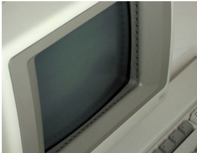
Fotografia 4. Optyczny ekran dotykowy zastosowany przez firmę HP w komputerze HP 150
