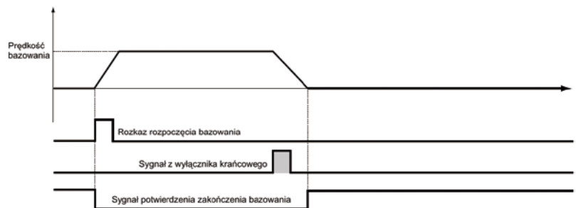
Rysunek 4. Bazowanie z wykorzystaniem wyłącznika krańcowego
