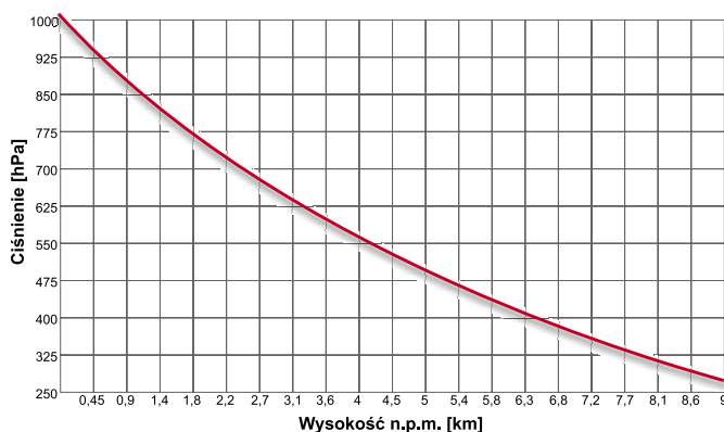
Rysunek 1. Wykres zależności bezwzględnego ciśnienia powietrza od wysokości n.p.m.
