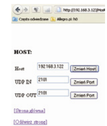
Rysunek 18. Ustawienie parametrów HOST dla konwertera nr 2
