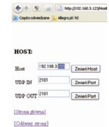
Rysunek 20. Uzupełnienie adresu broadcast dla konwertera nr 1
