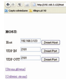
Rysunek 16. Ustawienie parametrów HOST dla konwertera nr 1
