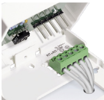
Fot. 4. Szczególnym przypadkiem złącza jest element z serii PT 1,5 –CLIP. Dzięki niemu można np. zrealizować wygodne przyłącze w panelu ściennym. Dolna część obudowy zawiera przyłącze przewodów, w które podczas montażu górnej części zawierającej PCB, wtykana jest listwa grzebieniowa
