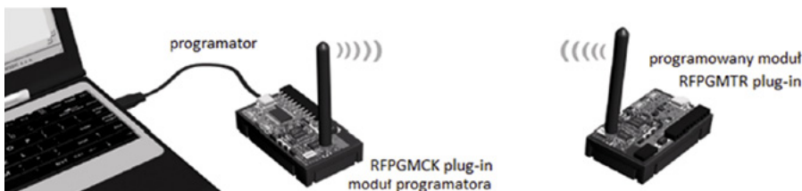
Rysunek 1. Konfiguracja sprzętowa niezbędna dla programowania RF PGM
