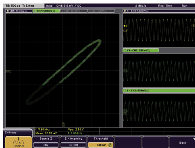
Rysunek 2. Tryb XYZ, w którym kanał Z jest wykorzystywany do modulacji jasności oscylogramu
