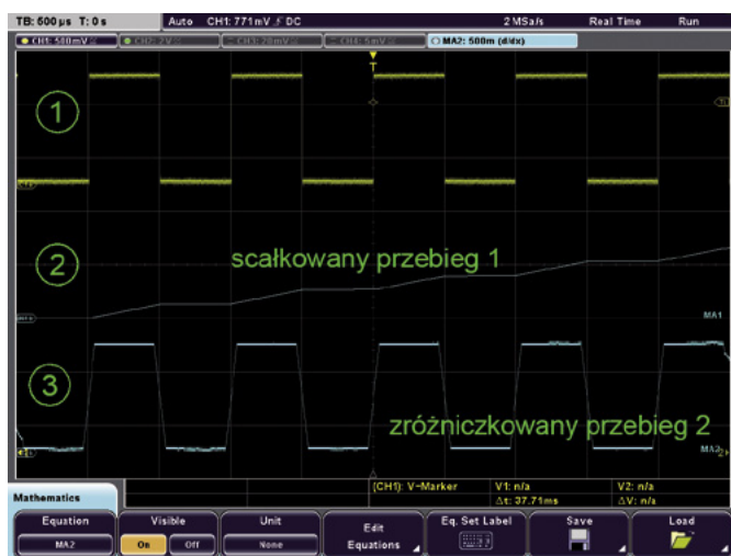
Rysunek 8. Oscylogramy uzyskane w wyniku zastosowania obliczeń matematycznych – całkowania i różniczkowania
