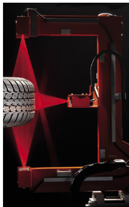
Fotografia 2. Wykrywanie wad ścian bocznych opony z wykorzystaniem pomiaru profilu za pomocą czujnika scanCONTROL
