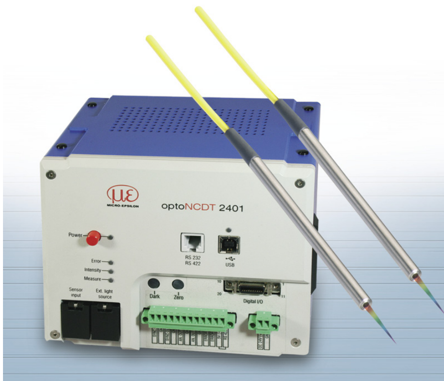
Fotografia 5. Konfokalny system czujników IFD 2401, z nowym kontrolerem i miniaturowymi czujnikami
