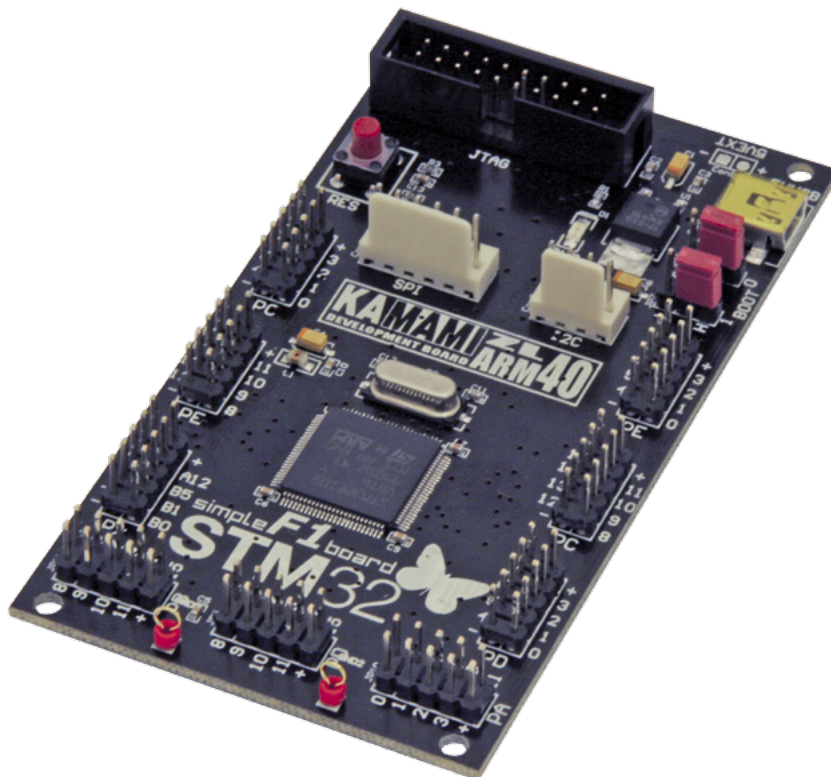
Fotografia 1. W zestawie ZL40ARM zastosowano mikrokontroler STM32F103 z rodziny STMF1
