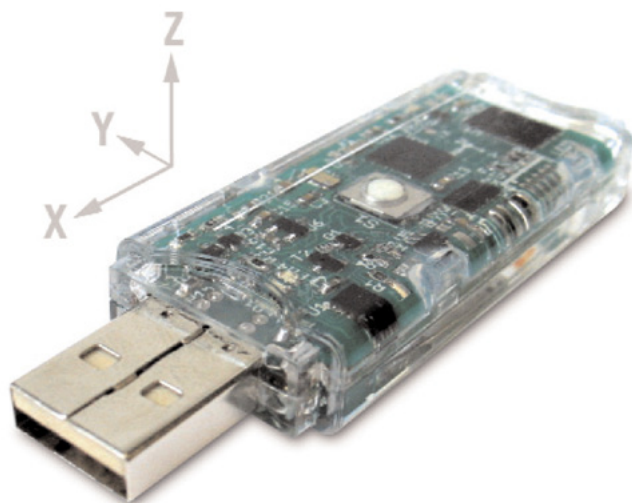
Rysunek 5. Ułożenie osi X, Y, Z względem obudowy
