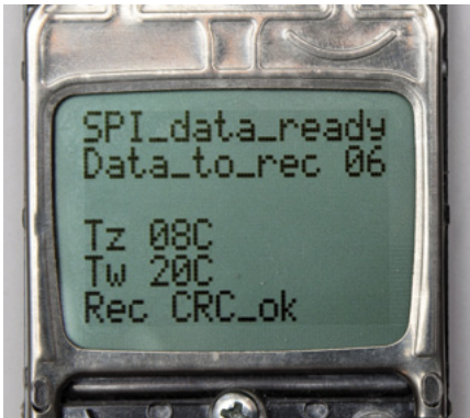
Fotografia 9. Ekran wyświetlacza hosta w trakcie pomiaru temperatury
