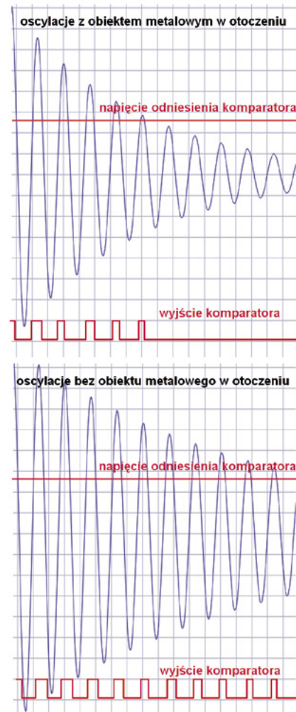
Rysunek 7. Oscylacje pojawiające się podczas odczytu czujnika indukcyjnego w otoczeniu bez obiektu metalowego oraz z obiektem metalowym
