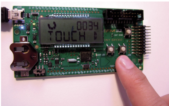
Fotografia 14. Użycie przycisków pojemnościowych jako touch slider'a
