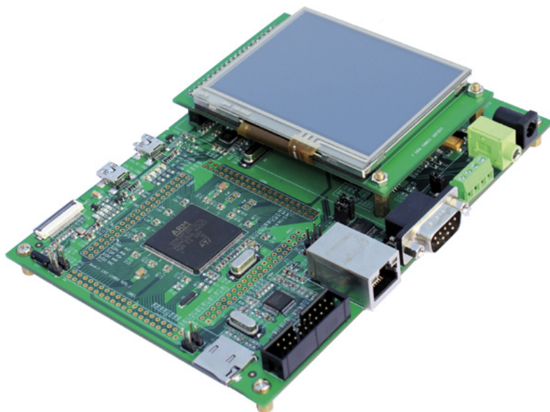
Fot. 5. Wygląd zestawu DevKit1207 firmy Embest (STM32F2)
