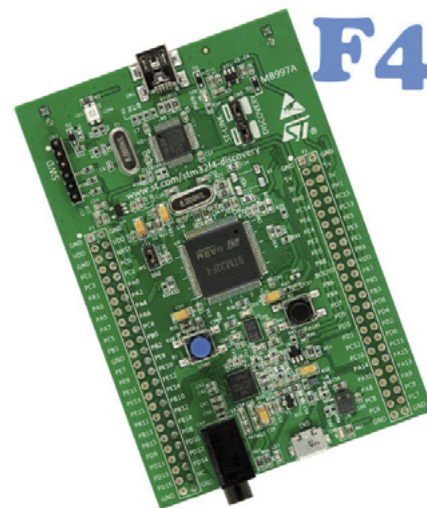
Fot. 6. Zestaw STM32F4Discovery (z mikrokontrolerem STM32F407VGT6)
