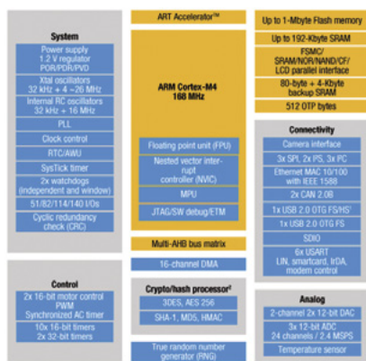
Rys. 1. Budowa mikrokontrolerów STM32-F4
