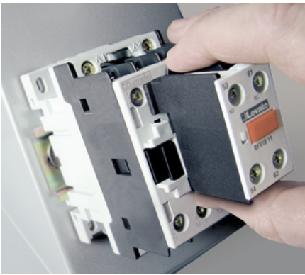
Fotografia 4. Pierwszy typ styczników, od 9 do 25A w AC3, można blokować mechanicznie i elektrycznie z drugim typem styczników od 26 do 38A w AC3; nowa blokada mechaniczna BFX50 02 zawiera również dwa wbudowane zestawy pomocnicze NC do blokady elektrycznej
