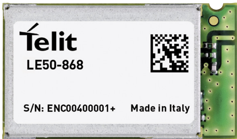
Fotografia 2. Moduł komunikacyjny LE50 do pracy w sieciach radiowych o topologii gwiazdy
