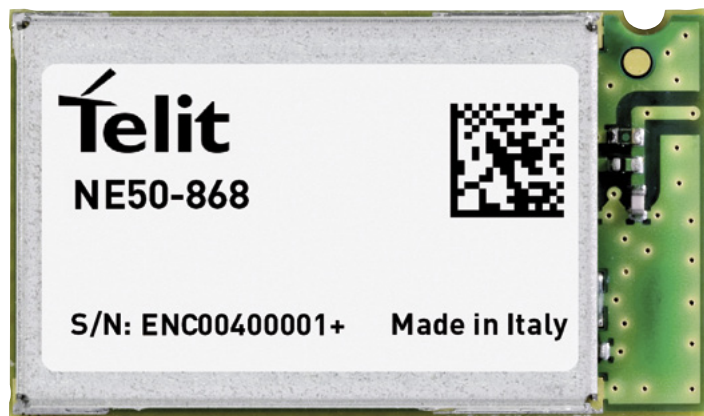
Fotografia 3. Moduł komunikacyjny NE50 do pracy w sieciach radiowych o topologii kraty
