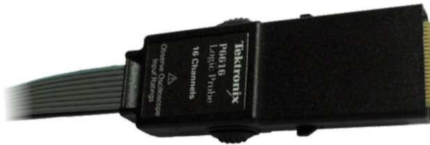
Fotografia 1. Wtyk sondy logicznej
