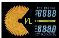
Rysunek 8. Wyświetlacz typu Multi-Color Twisted Nematic
