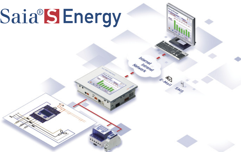
Rysunek 1. Schemat budowy systemu Saia S-Energy
