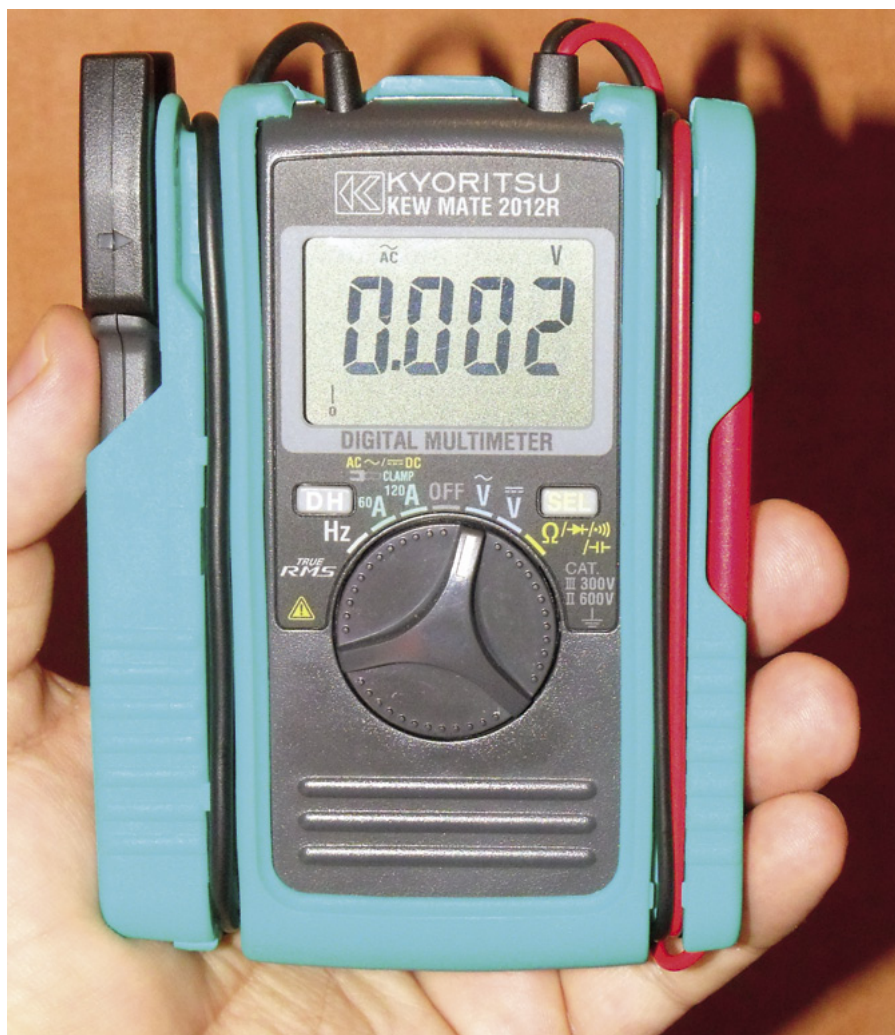
Fotografia 1. Wygląd miernika w etui. Po prawej stronie zasobnik przewodów pomiarowych, po lewej są umieszczone cęgi
