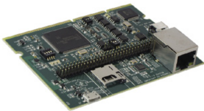
Rysunek 4. Moduł uruchomieniowy H52C1 Concerto controlCARD firmy Texas Instruments z procesorem dwurdzeniowym F28M35H52C1 Concerto
