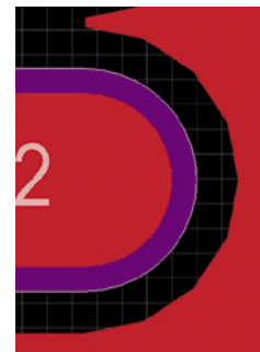
Rysunek 178. Niedokładności w wypełnieniu łuku
