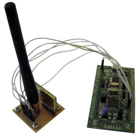
Rysunek 8. Wykonany węzeł transmisyjny
