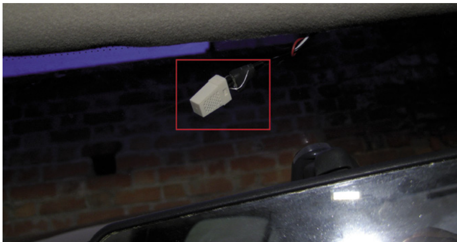
Fotografia 6. Czujnik wilgotności przedniej szyby 2
