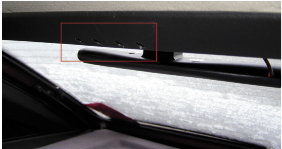
Fotografia 3. Czujnik temperatury i wilgotności w kabinie
