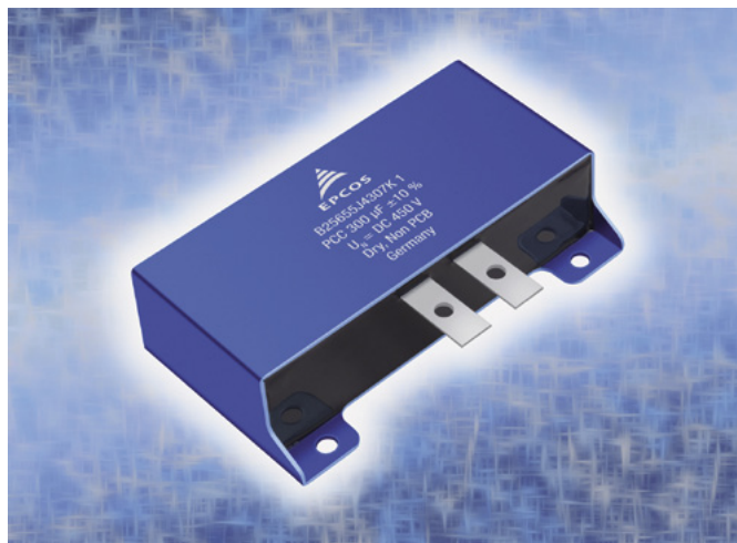
Fotografia 2. Kondensator PCC firmy Epcos. Zastosowana technologia budowy oraz wyprowadzenia dopasowane do modułów IGBT sprawiają, że cechują się one niską wartością indukcyjności zastępczej ESL
