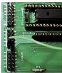
Fotografia 5. Połączenie linii RA0 złącza J13
