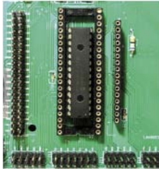
Fotografia 2. Umieszczenie mikrokontrolera PIC18F2320 w podstawce
