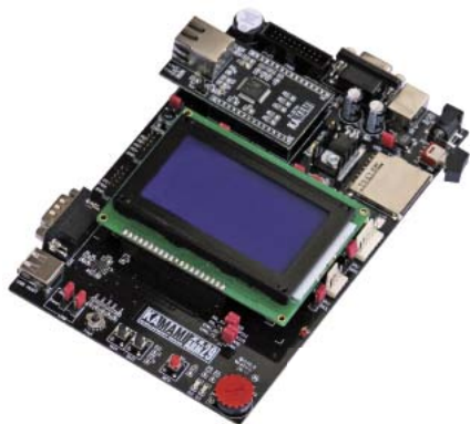
Fotografia 1. Wygląd zestawu ZL29ARM, który jest sprzętową bazą dla książki „Mikrokontrolery STM32 w sieci Ethernet”
