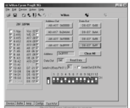
Rys. 6. Zakładka umożliwiająca edycję stanów na wyprowadzeniach podstawki ZIF32
