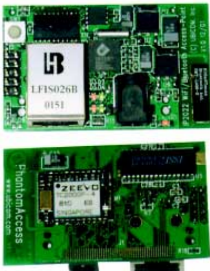
Fot. 5. Dwie wersje Access Point Bluetooth
