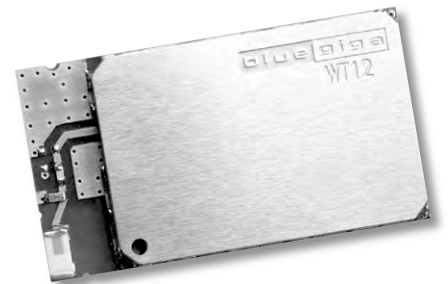
Fot. 1. Wygląd modułu Bluetooth WT12
