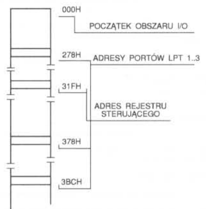
Rys. 3. Mapa adresowa obszaru I/O w komputerze PC z adresami zajętej przez kartę dźwiękową
