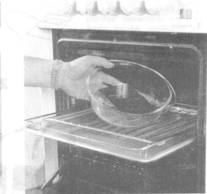
Fot. 3. Do suszenia płytkę pokrytą emulsją warto umieścić w żaroodpornym naczyniu
