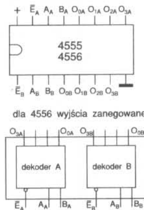
4555 podwójny dekodery 1 z 4 - stan aktywny H 4556 podwójny dekodery 1 z 4 - stan aktywny L
