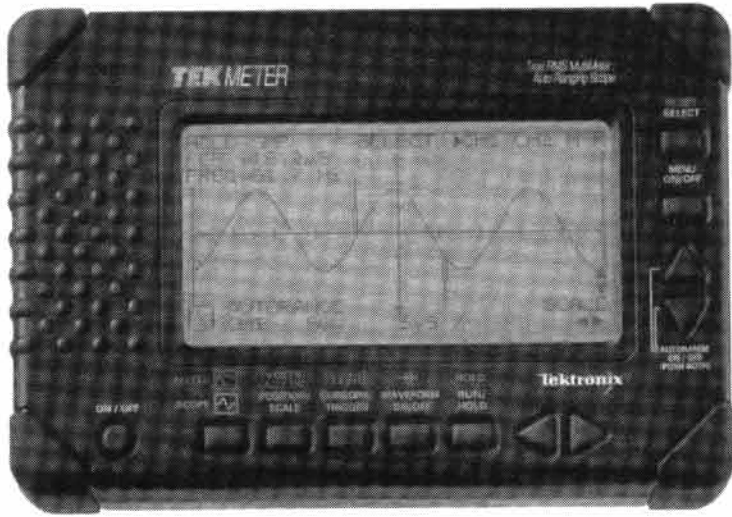
Rys. 30. Miniaturowy ręczny OPC uniwersalnego zastosowania - TEKMETER Tektronix
