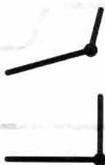
Rys. 14. Działanie Move | Drag End na ścieżki połączone przelotką.
