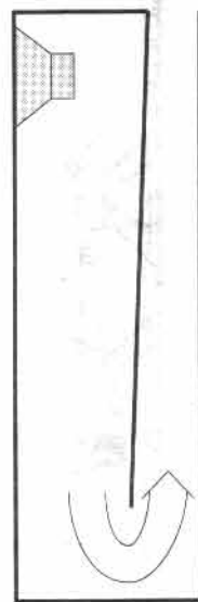
Rys. 7 Linia transmisyjna wg projektów firmy ISOPHDN - wyraźne zwężenie tunelu w połowie długości.
