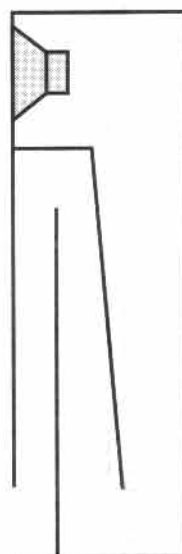
Rys. 6. Linia transmisyjna - bass-reflex w konstrukcjach firmy TDL.
