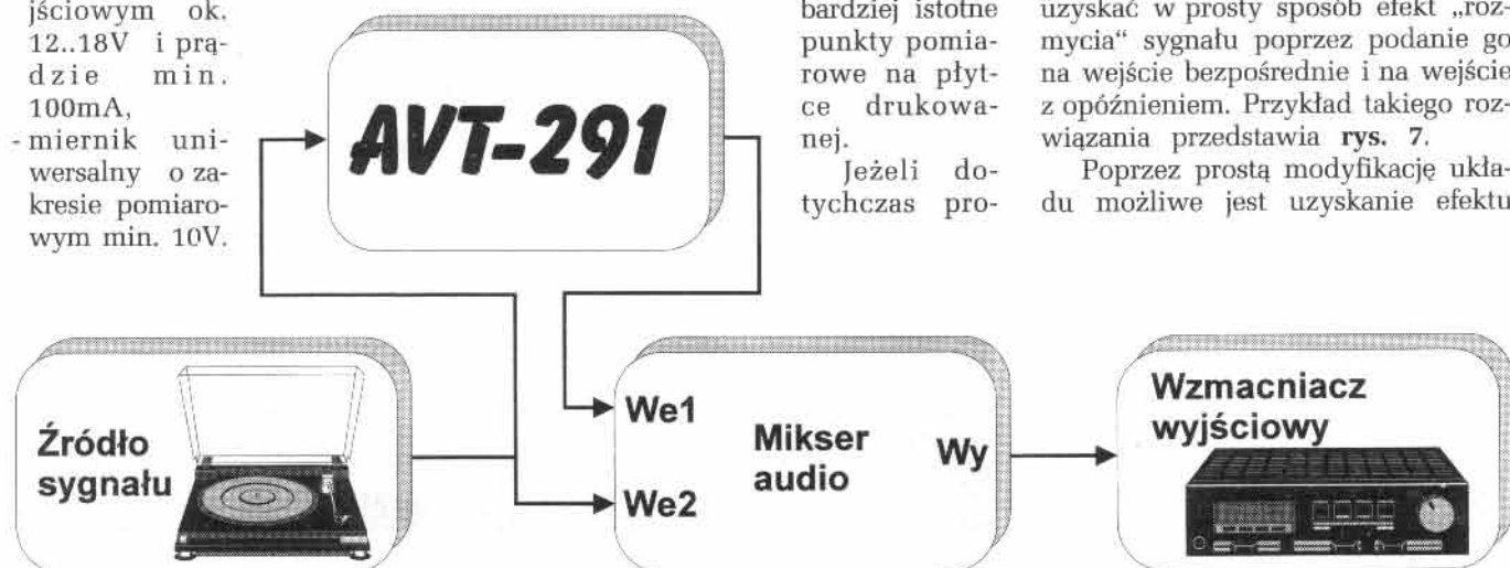
Rys. 7. Przykład zastosowania kamery pogłosowej w zestawie nagłośnieniowym.
