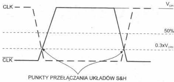
Rys. 2. Przebiegi sterujące wejściami zegarowymi.
