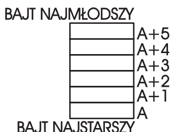
Rys. 1. Przyjęty przez autora sposób zapisu liczb wielobajtowych.
