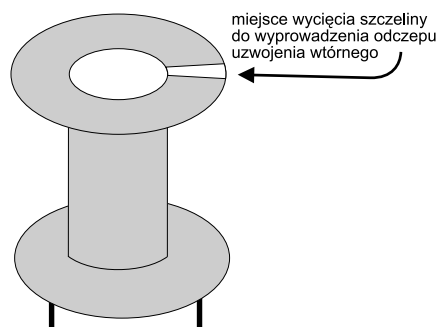
Rys. 4. Sposób wykonania karkasu transformatora Tr1.
