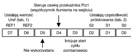
Rys. 3. Znaczenie bitów rejestru sterującego o adresie 315h.
