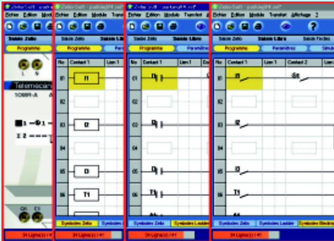
Rys. 2. Trzy języki programowania: symbole własne Zelio, symbole języka Ladder, symbole elektryczne.
