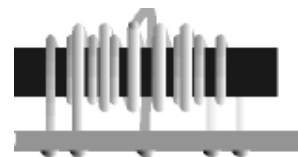
Rys. 4. Sposób nawinięcia cewki.
