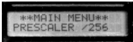
Rys. 4. Wygląd wyświetlacza podczas konfigurowania preskalera.
