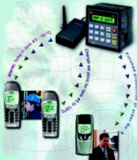
Fot. 1. Zestaw umożliwiający sterowanie i monitorowanie instalacji przemysłowej składający się ze sterownika M90 oraz modemu GSM.
