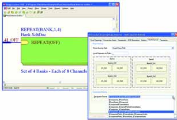
Rys. 6. nVisage obsługuje projekty wielokanałowe, zachowując hierarchię kanałów podczas całego procesu projektowego
