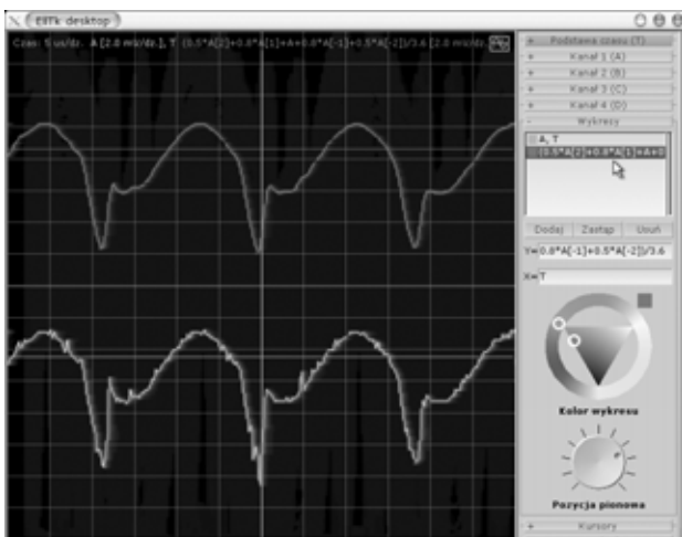
Rys. 13. Filtr FIR zrealizowany w postaci funkcji matematycznej
